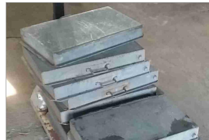
Figure 205 – Plaques eutectiques de la Penn Ar Bed (Crédit MG 2016)
