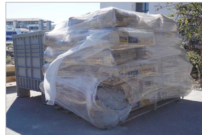
Figure 227 – Palette de sac de ciment endommagée (Crédit MG 2016)
