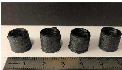
**Figure II-9** : Photographie d'échantillons de graphène imprimés en forme de cylindre creux par impression 3D après lyophilisation.
