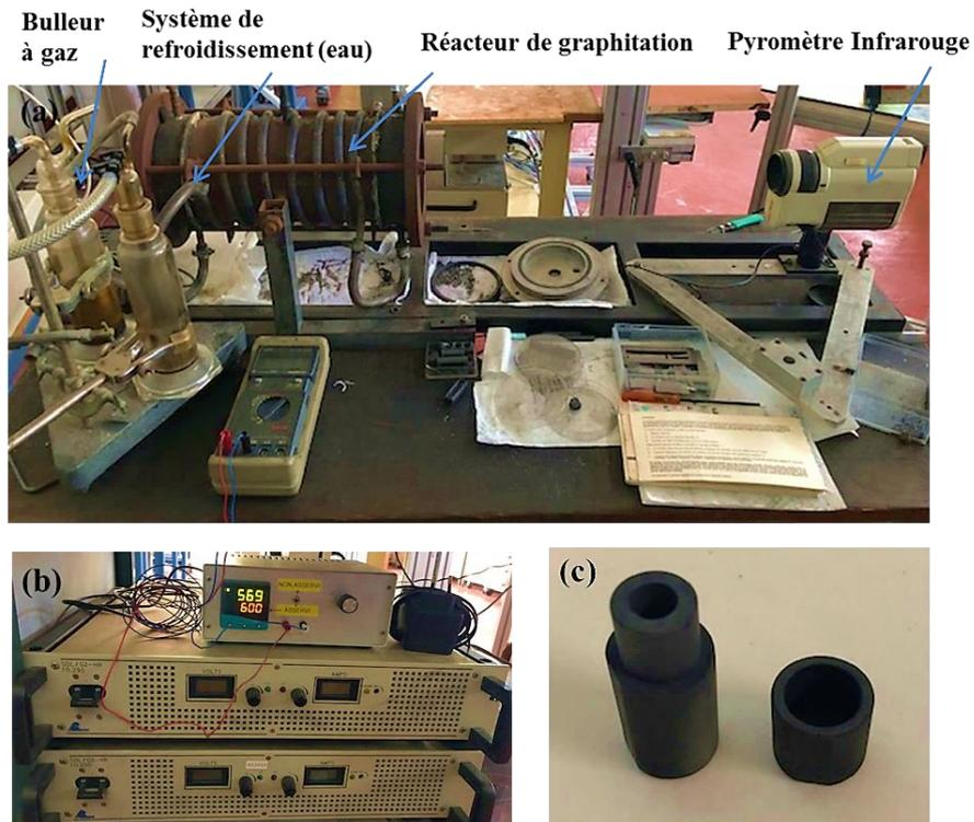
**Figure II-12 :** Photographies (a) du montage de graphitisation, (b) des génératrices basses tensions et du programmeur de température, (c) d'un creuset en graphite cylindrique creux refermable dans lequel sont placés les échantillons.
