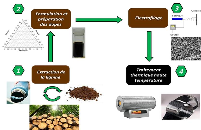
**Figure I-18** : Représentation schématique des étapes pour l'élaboration de nanofibres de carbone à base de lignine.
