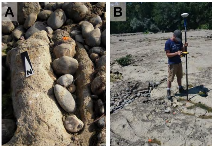
Figure 1.39 : (A) Forme en sillon à l'intersection d'un transect symbolisé par le fil avec orientation de cette dernière. (B) Lever de la position d'une forme par DGPS.
