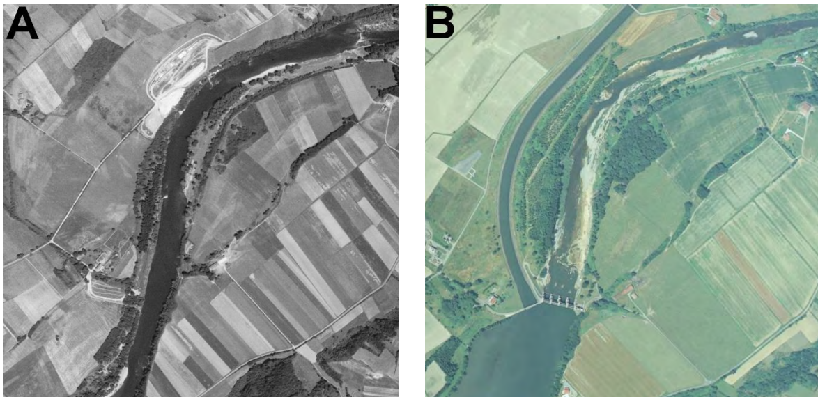
Figure 2.28 : Evolution du chenal sous l'effet de la mise en place d'un barrage mobile dans le secteur de Cazères sur la Garonne amont entre (A) 1962 et (B) 1993 (IGN). Les deux photographies présentent des débits relativement proches qui sont respectivement de 128 \text{ m}^3 \cdot \text{s}^{-1} et 103 \text{ m}^3 \cdot \text{s}^{-1} .
