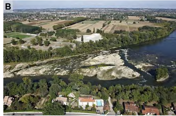
Figure 1.26 : (A) seuil de Portet-sur-Garonne situé en aval de la confluence avec l'Ariège ; (B) seuil de Beauzelle situé 10 km en aval de Toulouse ; (C) seuil de Grenade situé 25 km en aval de Toulouse (Photos SMEAG).
