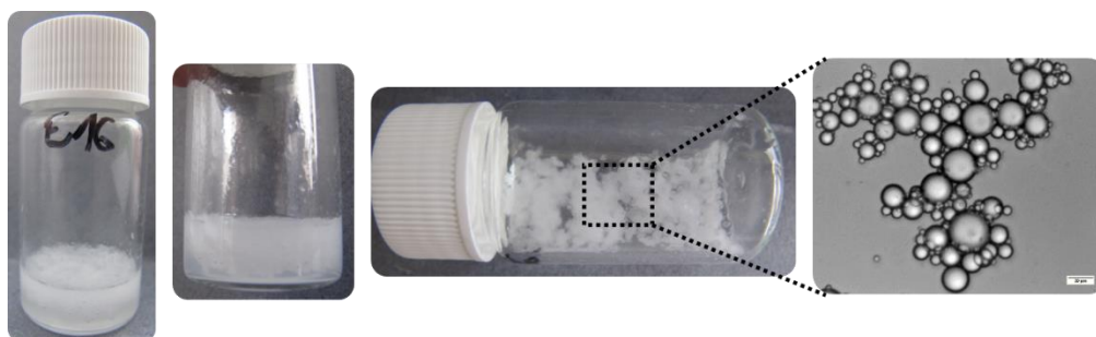
Figure 4.18 : Emulsion formulée avec des microgels de grande taille réticulés à 2,5% à une concentration de 0,06% m à l'aide d'un dispositif de doubles seringues. Barre d'échelle : 20 \mu\text{m} .
