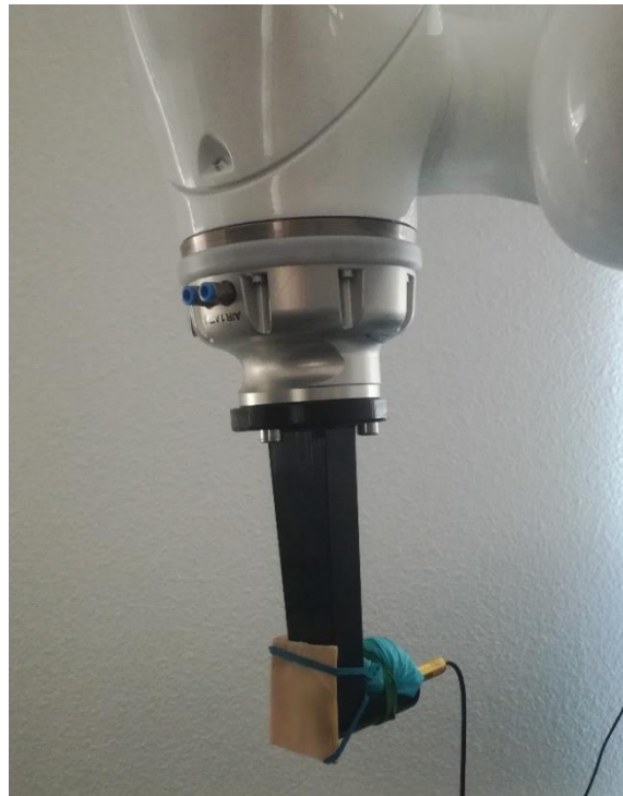
Figure 39 – Echantillon de crâne de cochon monté sur le support du PCD amovible.
