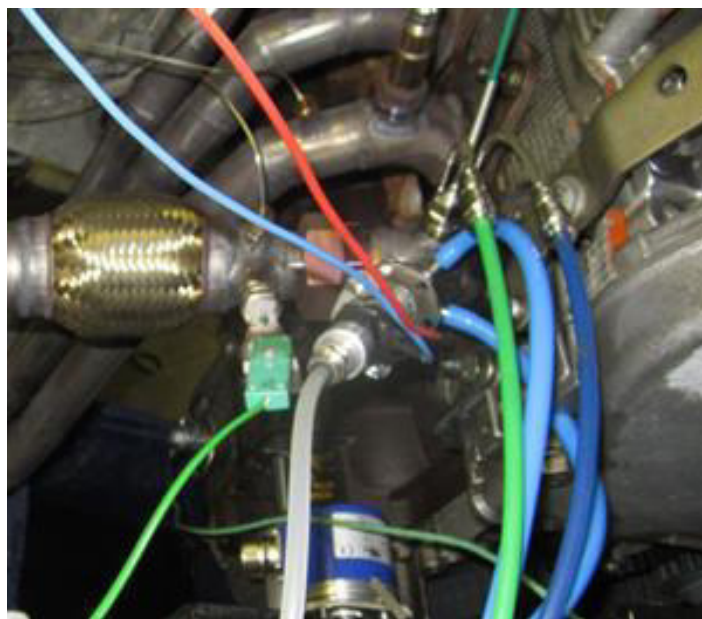
Figure 50 Electrovanne rapide de prélèvement installée sur la ligne d'échappement
