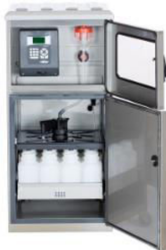
Figure 28 : Préleveur d'eau automatique fixe Bühler 4011 (Hach, 2018).
