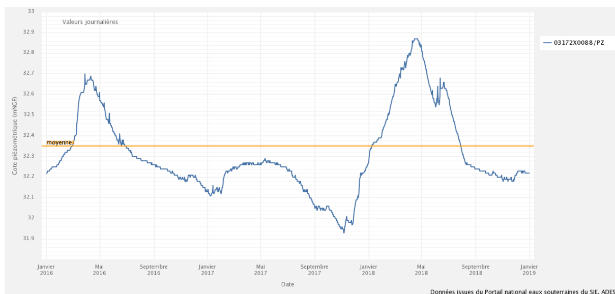
Figure 53 : Evolution du niveau de nappe relevé sur le piézomètre le plus proche de la station de Betton, La Petite Noë (Saint-Grégoire - 35), d'après les données issues du Portail national eaux souterraines du SIE, ADES
