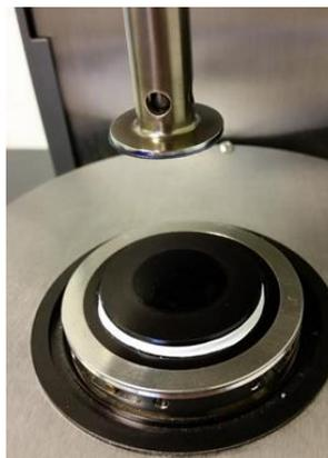
Figure 117 : Couche lubrifiante déposée après retrait d'un échantillon à 80% de DEP
