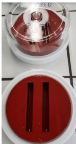
Figure 73 : Production des échantillons dans des moules silicones sous cloche
