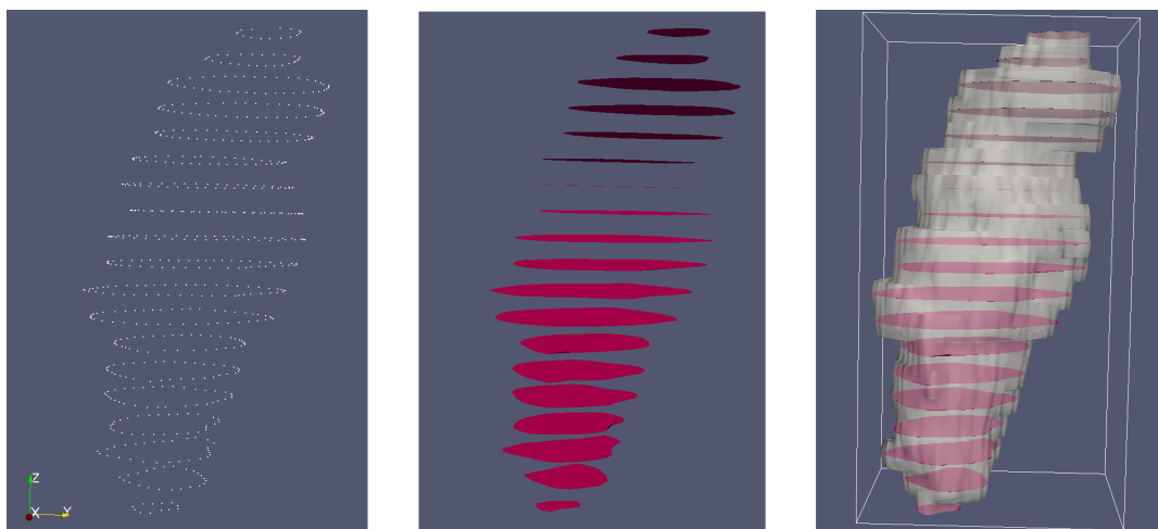
FIGURE 1.4 – (à gauche) Les listes de points sont organisées par ROI 2D. (au milieu) Cela permet de créer des polygones dans le plan et de remplir des coupes. (à droite) Le passage à la 3D se fait simplement par extrusion perpendiculaire.
