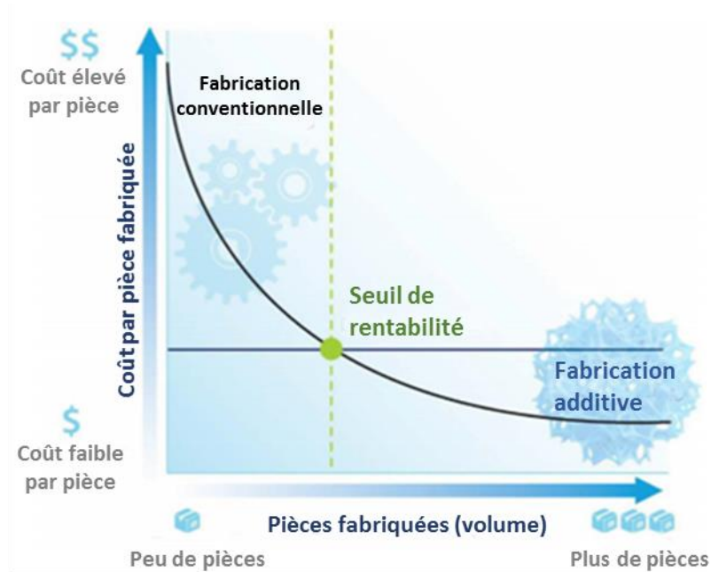
Figure 71 - Economie d'échelle : Comparaison entre l'usinage conventionnel et la fabrication additive (Janssen et al. , 2014)
