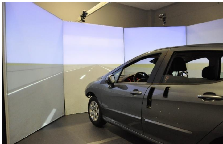
Figure 6.3: Simulateur de conduite pleine échelle statique utilisé (IFSTTAR).
