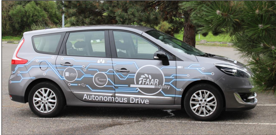
FIGURE 4.1 – Prototype de véhicule autonome basé sur un Renault Grand Scenic sur lequel le cas d'étude a été réalisé
