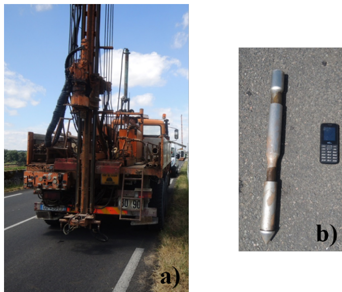
FIGURE V.9 – a) Machine Gouda et b) pointe utilisée sur la digue de protection de St-Clément-des-Levées pour les essais CPT.
