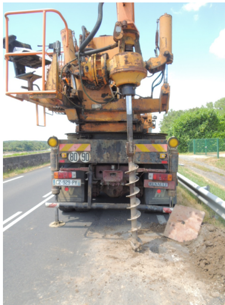
FIGURE V.6 – Foreuse carotteuse Texoma sur la digue de St-Clément-des-Levées lors de la campagne de reconnaissance.
