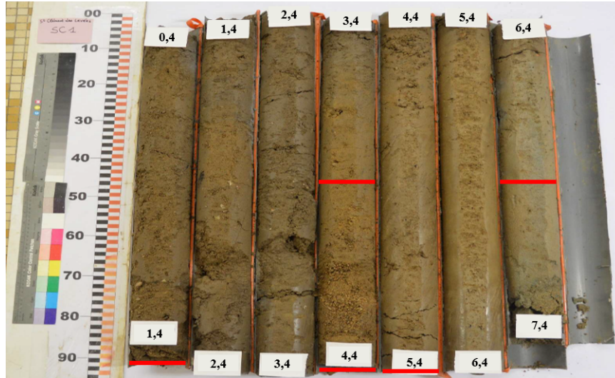
FIGURE V.7 – Exemple de la carotte n° 1 avec délimitations établies par le technicien au laboratoire (en rouge), profondeurs renseignées sur les étiquettes en considérant la profondeur 0 m comme étant la position verticale des électrodes (1.10 m sous la surface).
