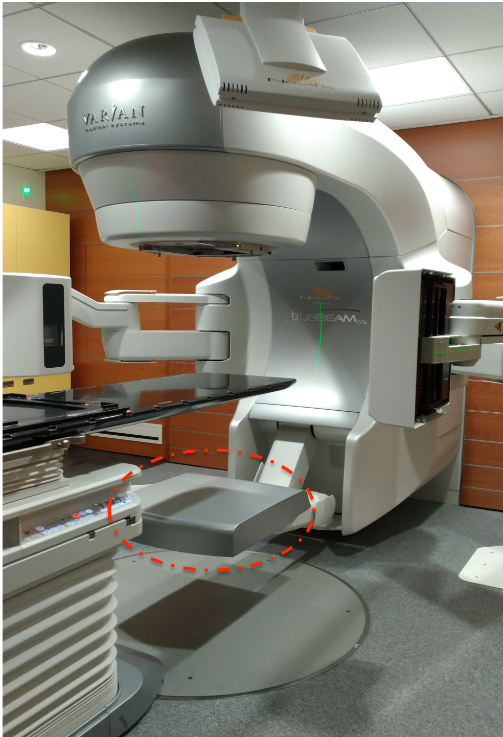
Figure II-1 : Accélérateur linéaire Clinac TrueBeam STx (Varian Medical Systems) et son imageur portal aS-1200 au silicium amorphe monté sur un bras métallique rétractable (entouré en rouge). L'EPID est situé derrière le patient positionné sur la table de traitement.
