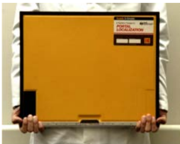
Figure I-3 : Cassette de dimensions 35 cm × 43 cm × 1.4 cm utilisée en dosimétrie des faisceaux de photons. Image issue des travaux d'Antonuk et al, (43).
