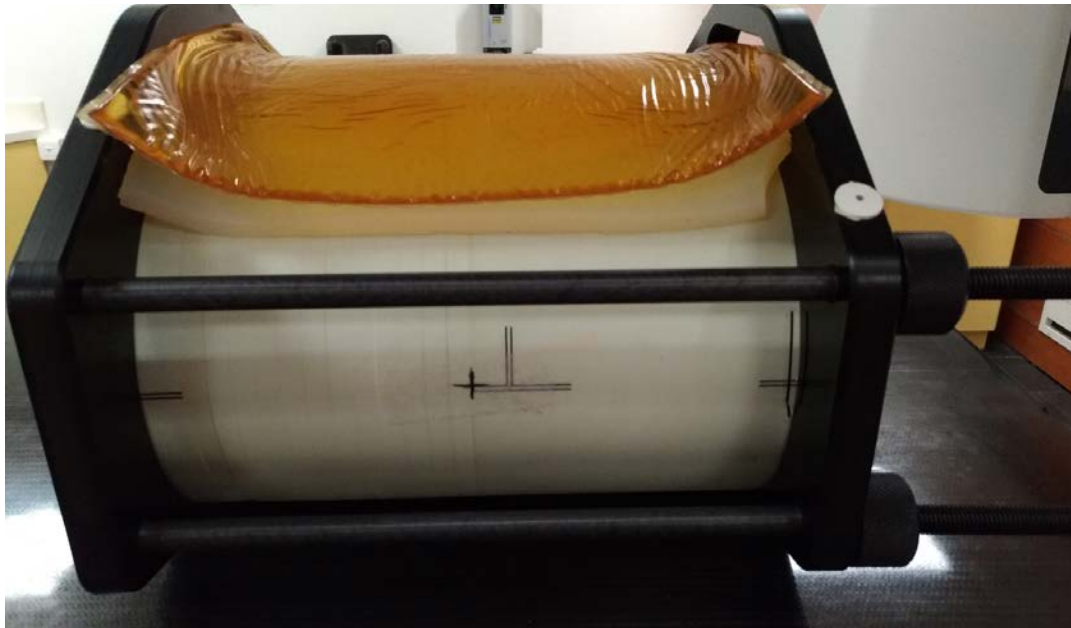
Figure VI-12 : Bolus de 1.5cm d'épaisseur placé sur le fantôme CIRS-thorax pour simuler une augmentation du volume.
