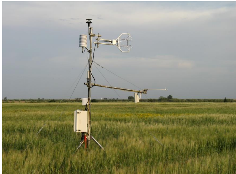
Figure III-2.4: Station de mesure de flux sur la parcelle de blé sec de Ben Salem
