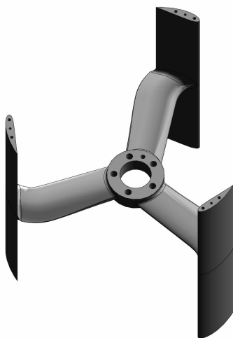
Figure 2.1 Vue de la turbine Darrieus utilisée pour les expériences et les simulations dans le cadre de cette thèse
