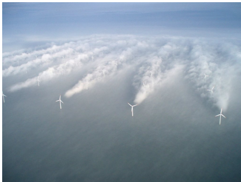
Figure 1.6 Photo des sillages générés par un parc d'éoliennes. Source : Christian Steiness / Vattenfall (Horns Rev Offshore Wind Farm, Denmark)
