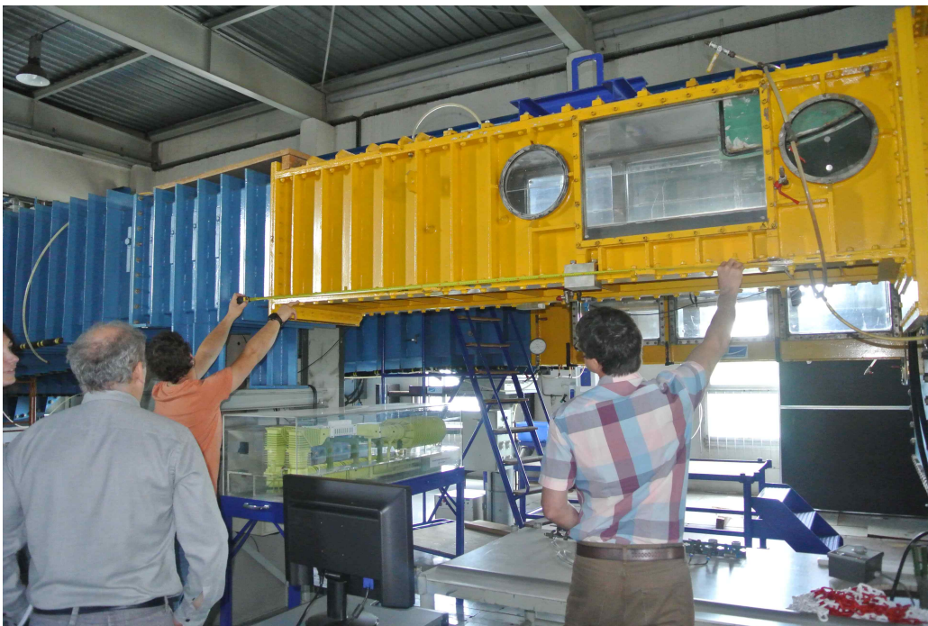
Figure 3.1 Photo de la section d'essai du tunnel TH2 du CERG (partie en jaune). L'écoulement a lieu de droite à gauche sur cette photo
