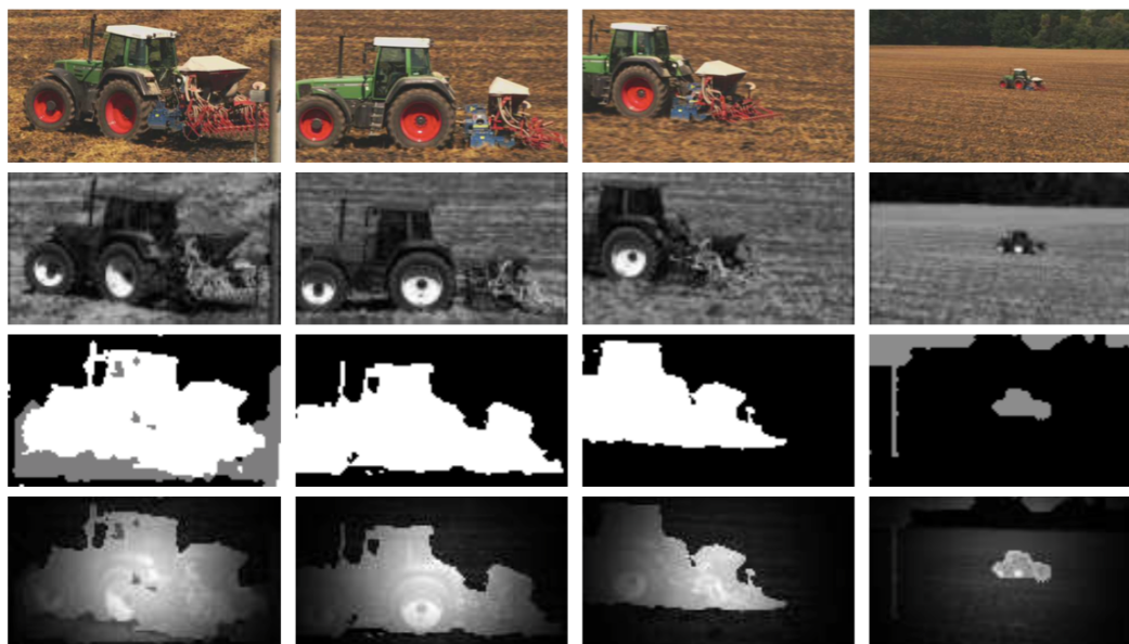
FIGURE 7.14 – Cartes de saillance pour Tractor (segments 13 à 16), avec de haut en bas : les images originales, les cartes de saillance spatiale, celles de saillance temporelle, puis celles de saillance spatio-temporelle (extrait de [38]).
