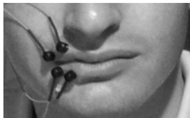
Figure II-8. Positionnement des capteurs électromyographiques de surface pour mesurer l'activité des muscles labiaux lors de la production de parole intérieure.
