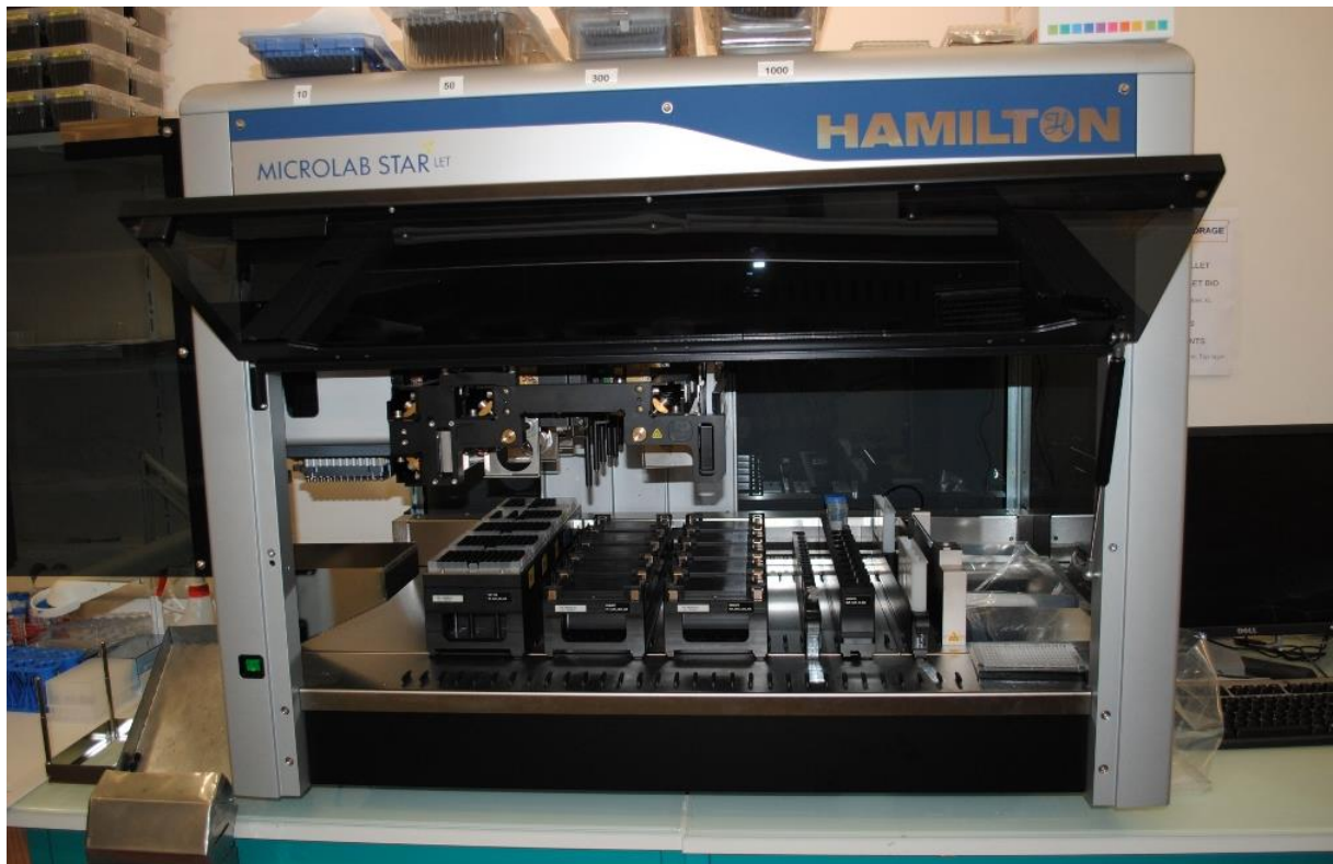
Figure 96 : Robot de pipetage Hamilton.
