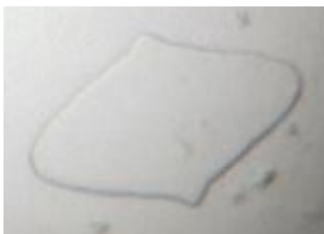
Figure 42 : Unique cristal ayant permis de résoudre la structure du complexe binaire ComR Sve / XIP Sve . Le cristal a été obtenu dans 0.1M MgCl 2 , 0.1M tri-Sodium Citrate pH 5.5, 12% PEG4000 et 0.1M NaCl. La goutte contenait la protéine à 10 mg/ml, le peptide XIP 10 fois en excès et l'ADN PcomX 20pb 3 fois en excès.
