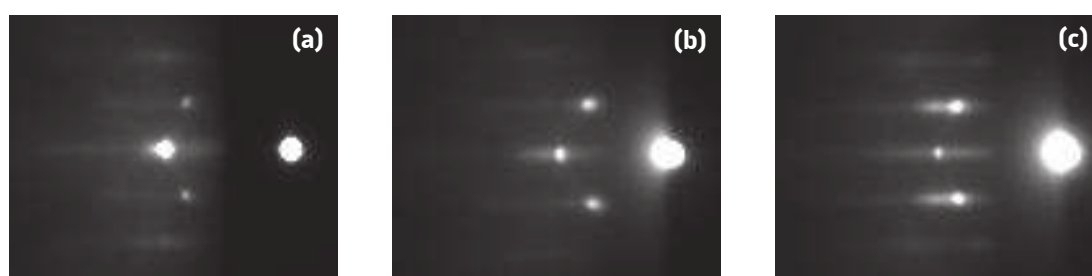
Figure IV-3 : Clichés de diffraction RHEED enregistrés le long de l'azimut [110] du substrat STO(001) terminé en TiO 2 obtenu à 700 °C et 5.10 -7 mbar (a), avec une pression partielle en oxygène de 0,1 mbar (b) et après la croissance de l'empilement complet LSMO#1|STO|LSMO#2 enregistré à 500 °C sous la même pression de 0,1 mbar (c).
