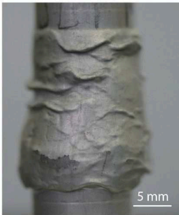
Figure V-15 : Expérience PP592. (a) Courbes rhéologiques \sigma en fonction de \epsilon obtenues à 3kbar et 850°C pour différentes vitesses de déformations appliquées. (b) Photo de l'échantillon après expérience, encore dans sa chemise en fer. (c) Diagramme du log de la viscosité apparente en fonction de la vitesse de déformation. (d) Diagramme du log de la vitesse de déformation en fonction du log de la contrainte.
