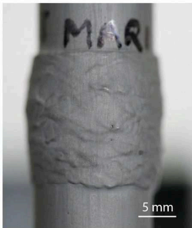
Figure V-19 : Expérience PP591 .(a) Courbes rhéologiques \sigma en fonction de \epsilon obtenues à 3kbar et 850°C pour différentes vitesses de déformations appliquées. (b) Photo de l'échantillon après expérience, encore dans sa chemise en fer. (c) Diagramme du log de la viscosité apparente en fonction de la vitesse de déformation. (d) Diagramme du log de la vitesse de déformation en fonction du log de la contrainte.
