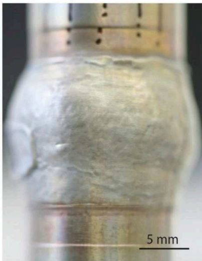
Figure V-12 : Expérience PP569. (a) Courbes rhéologiques \sigma en fonction de \epsilon obtenues à 3kbar et 850°C pour différentes vitesses de déformations appliquées. (b) Photo de l'échantillon après expérience, encore dans sa chemise en fer. (c) Diagramme du log de la viscosité apparente en fonction de la vitesse de déformation. (d) Diagramme du log de la vitesse de déformation en fonction du log de la contrainte.
