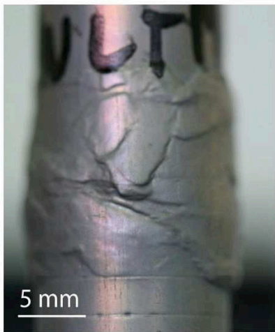
Figure V-14 : Expérience PP595. (a) Courbes rhéologiques \sigma en fonction de \epsilon obtenues à 3kbar et 850°C pour différentes vitesses de déformations appliquées. (b) Photo de l'échantillon après expérience, encore dans sa chemise en fer. (c) Diagramme du log de la viscosité apparente en fonction de la vitesse de déformation. (d) Diagramme du log de la vitesse de déformation en fonction du log de la contrainte.
