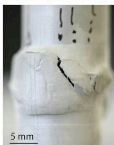
Figure V- 22 : Photos de l'échantillon de stronalites (77) PP570 après expérience : (en haut) Image MEB de l'échantillon, les zones de fractures principales sont soulignées en rouge et les plans S-C en blanc. (à gauche) dans sa chemise en fer.
