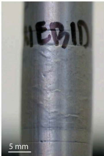
Figure V-20 : Expérience PP596.(a) Courbes rhéologiques \sigma en fonction de \dot{\epsilon} obtenues à 3kbar et 850°C pour différentes vitesses de déformations appliquées. (b) Photo de l'échantillon après expérience, encore dans sa chemise en fer. (c) Diagramme du log de la viscosité apparente en fonction de la vitesse de déformation. (d) Diagramme du log de la vitesse de déformation en fonction du log de la contrainte.
