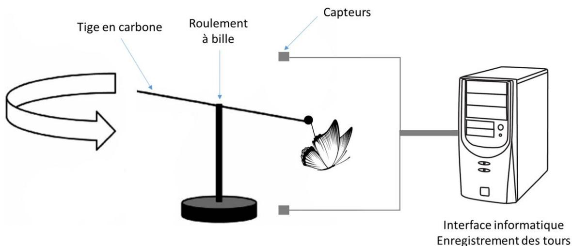
Figure 12. Schéma de fonctionnement d'un manège de vol.
