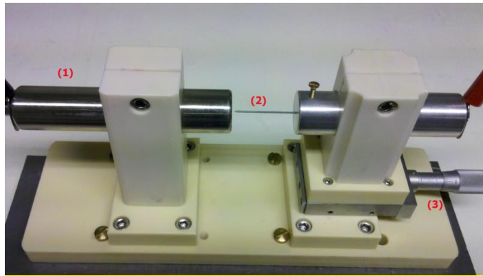
Figure I.21 : photographie de la configuration pointe/plan avec (1) électrode plan (2) électrode pointe (3) vis micrométrique.
