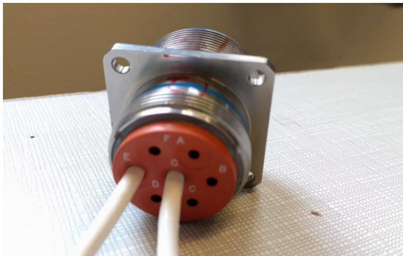
Figure IV.5 : photographie de la face arrière de l'embase femelle. Le serre-fil isolant est en orange.
