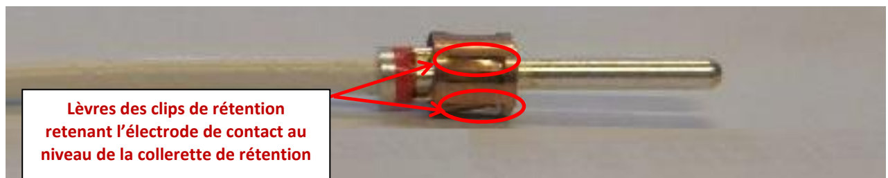
Figure II.12 : photographie d'une électrode de contact mâle insérée dans le clip de rétention avec un zoom sur les lèvres du clip.
