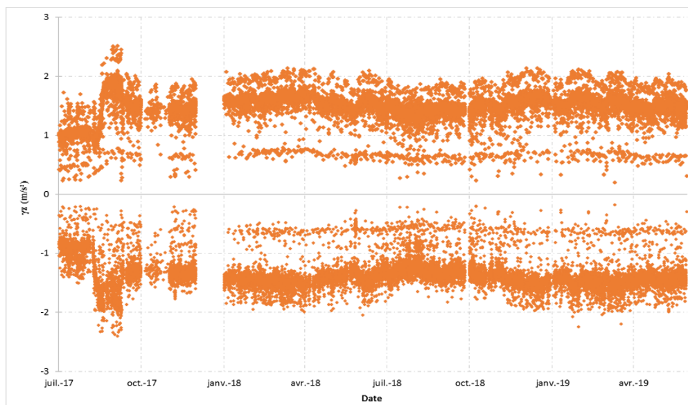
Graphique 11 – Accélérations verticales maximales et minimales mesurées par l'accéléromètre AS3, situé entre les deux rails, sur la section granulaire, pendant la phase d'exploitation commerciale, par ordre chronologique de passage des trains
