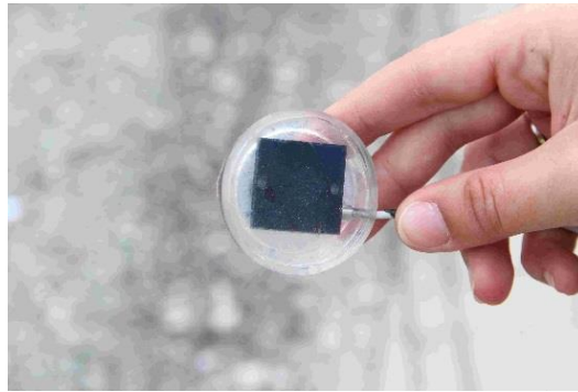
Figure II.5 - Accéléromètre coulé dans la résine
