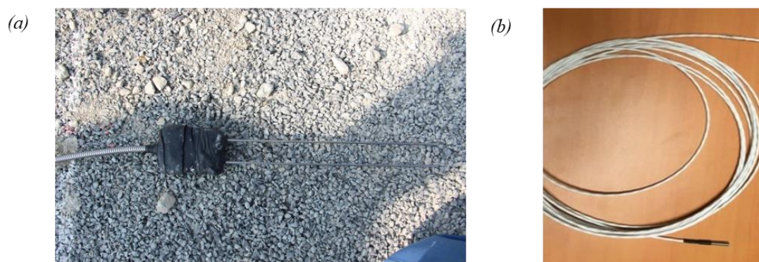
Figure II.3 - (a) sonde d'humidité (b) sonde de température
