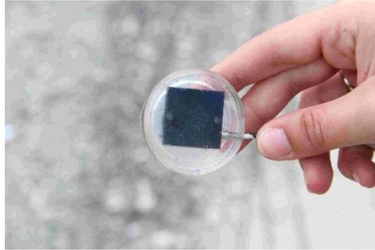
Figure II.5 - Accéléromètre coulé dans la résine
