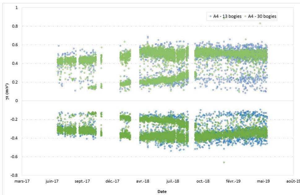
Graphique 29 - Accélérations verticales maximales et minimales mesurées par l'accéléromètre A4 placé entre les deux rails, sur la section bitumineuse 4, pendant la phase d'exploitation commerciale, en fonction du type de train
