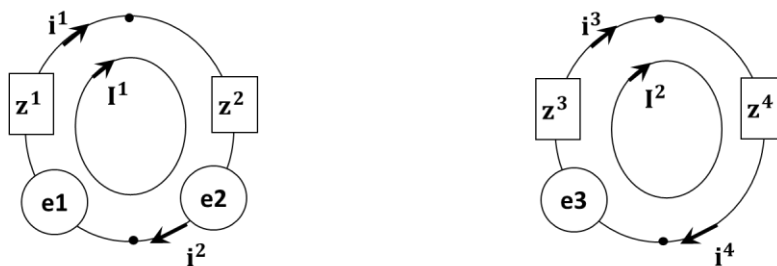
Figure 2-14 : Représentation des courants dans l'espace des mailles et l'espace des branches dans le cas d'un réseau avec 2 mailles et 4 branches
