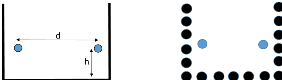
Figure 4-31 : Schéma équivalent du couplage entre deux conducteurs au sein d'une goulotte
