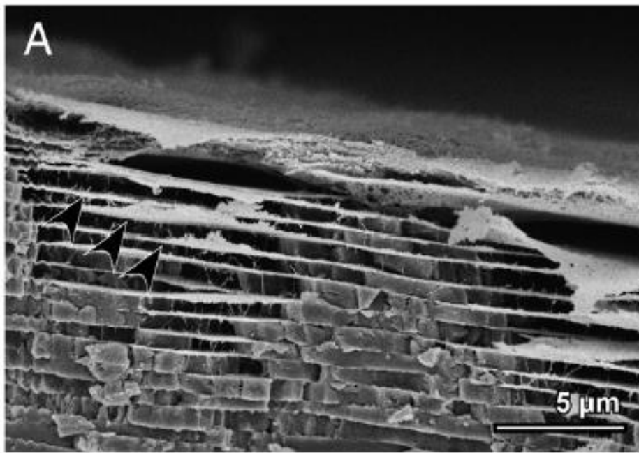
Figure 29 : Cliché de MEB du front de croissance de la nacre après traitement au glutaraldéhyde et point critique du CO 2 en vue de préserver les feuillets organiques parallèles marqués par les flèches noires – D'après Heinemann et al., 2011
