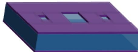
3<sup>ème</sup> oxydation thermique,
