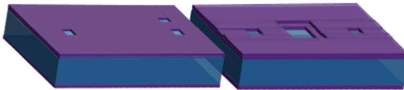
Pulvérisation pleine plaque d'une couche de Cr/Au  $\sim 10/150\text{ nm}$
