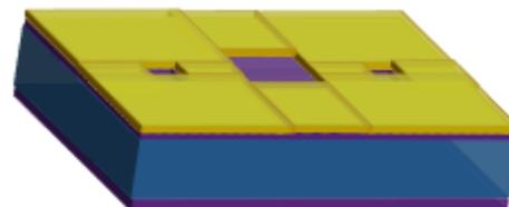
Structuration de l'électrode supérieure
