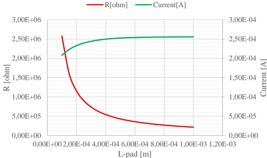
FIG. 4.39 - Évolution de la résistance due au substrat et son courant correspondant en fonction de la taille du pad de reprise de contact pour  $\rho = 10\,000\ \Omega \cdot \text{cm}$  et une tension DC de 100 V.
