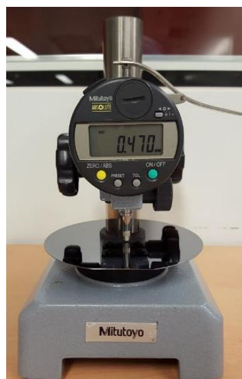
FIG. 5.5 - Mesure de l'épaisseur d'une plaque en silicium avec un comparateur mécanique.
