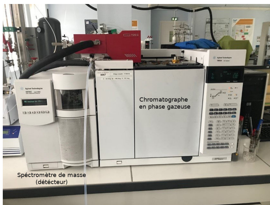
FIGURE 2.4 – Photo d'un GC-MS. Le bécher en bas à droite donne une idée des dimensions d'un tel appareil.
