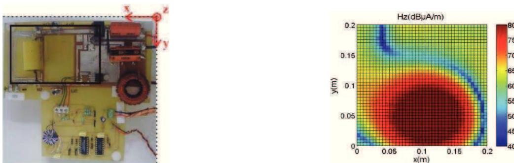
Figure II.30.2 : Photographie du convertisseur Buck étudié et le champ magnétique proche mesuré (composante-z),  $f = 17,9\text{MHz}$ .
