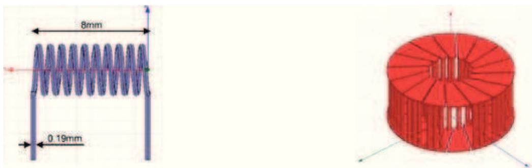
**Figure II.18 :** a) Deux structures de formes solénoïde et torique.
