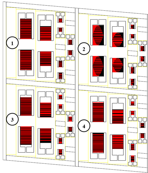
Figure 5-5 : Fenêtre de photo-répétition contenant les vingt systèmes de transducteur en transmission.
