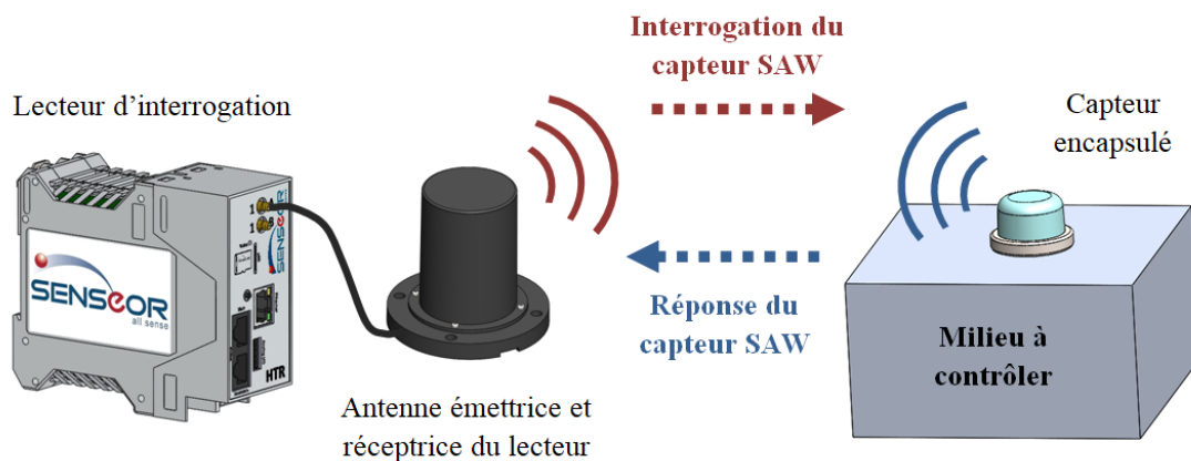
Figure 1-7 : Schéma de principe d'interrogation d'un capteur SAW.
