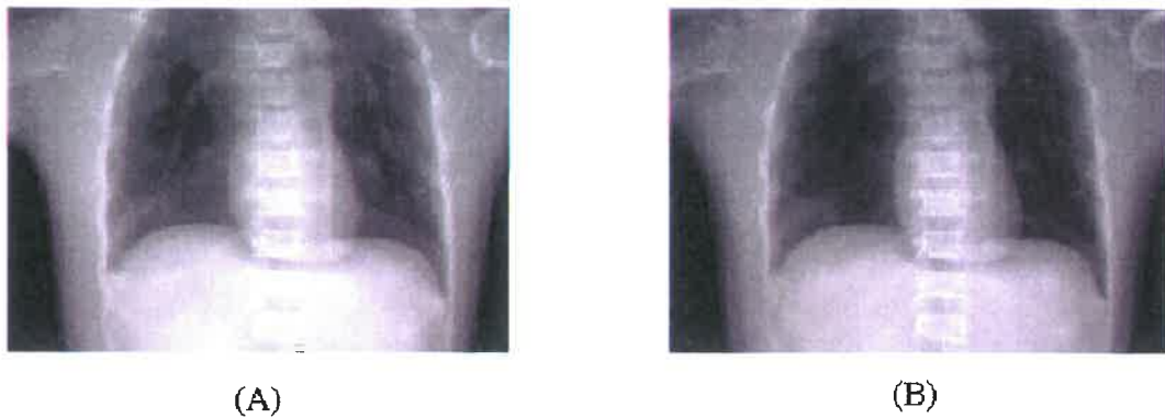
FIG. 3.10 – Résultats en radiographie. (A) Image sans correction en diffusé capteur. (B) Image avec correction en diffusé capteur.
