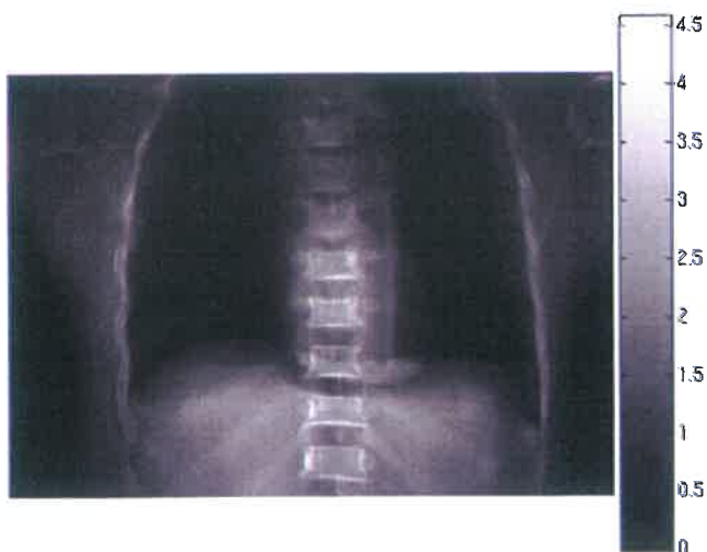
FIG. 5.10 - Rapport du rayonnement diffusé sur le primaire pour une acquisition de face du fantôme cylindrique.
