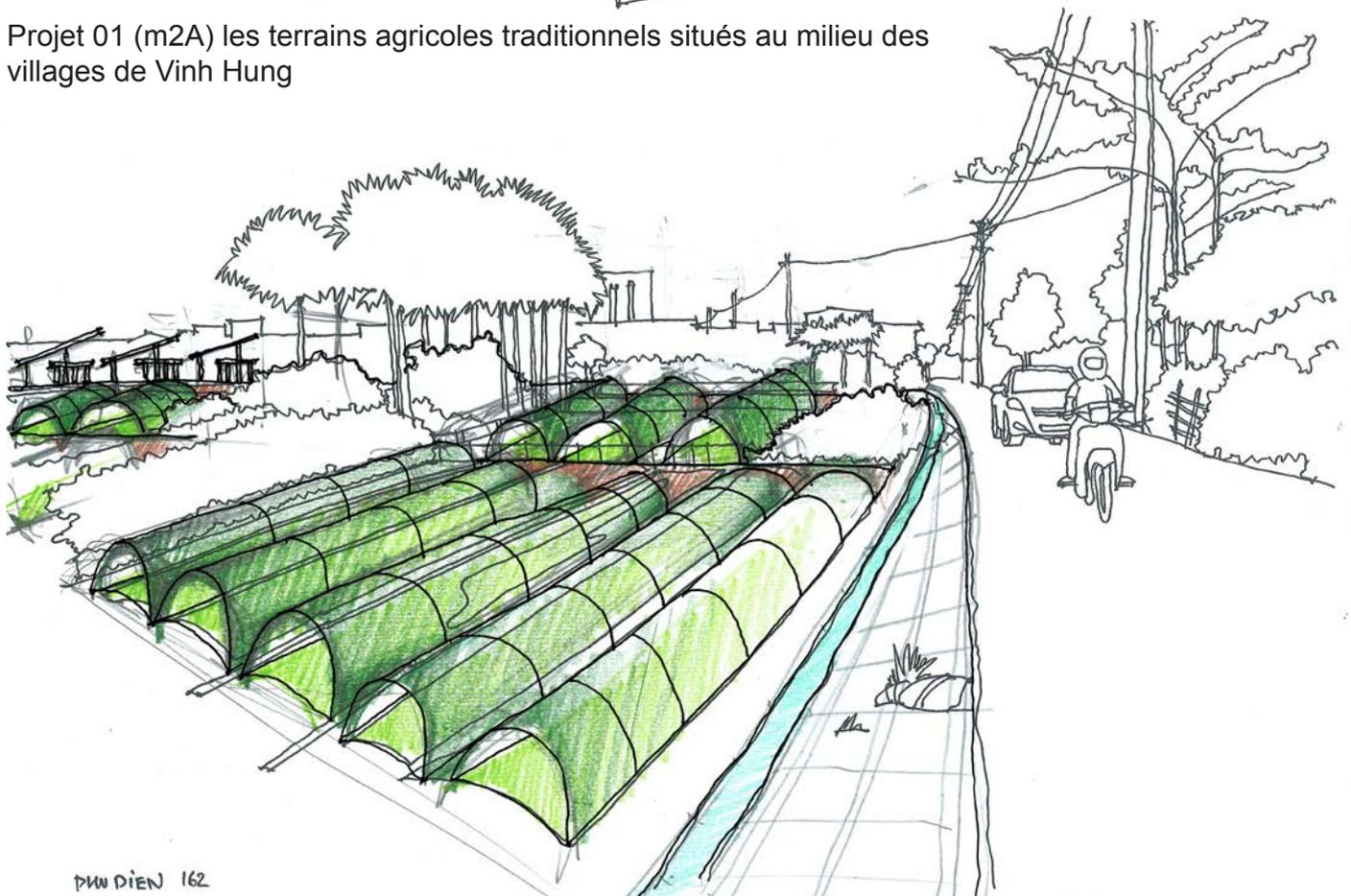
réseaux d'eau et d'énergie de la maison seront liés avec ceux des champs agricoles. Par exemple, l'eau de pluie sera récupérée dans les bassins et sert à arroser les plantes par un système de pompage. Ce système fonctionne par l'électricité qui vient des panneaux solaires sur les toits des maisons. En plus, grâce au petit stockage du biogaz (eT8), les déchets organiques peuvent produire de l'énergie.
