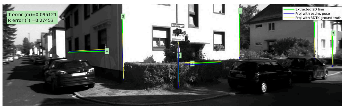
FIGURE 2.21 – Image extraite du jeu de données KITTI . Projection de lignes 3D sur l'image à l'aide de notre méthode de PnL.
