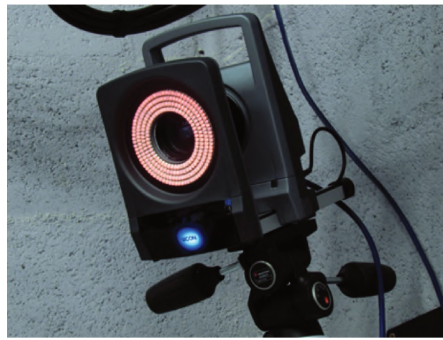
FIGURE 2.7 – Une caméra infrarouge T40S, de la marque Vicon
