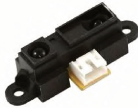
FIGURE 1.21 – Capteur de proximité infrarouge SHARP GP2Y0A21YK.
