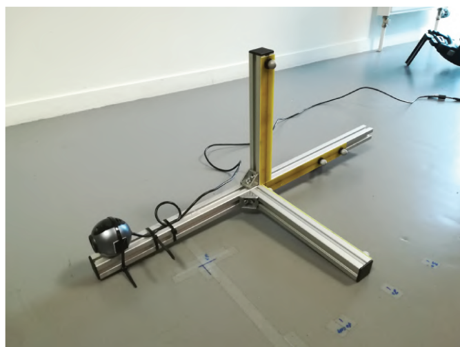
FIGURE 2.10 – Caméra montée sur un support rigide, lui-même muni de marqueurs Vicon
