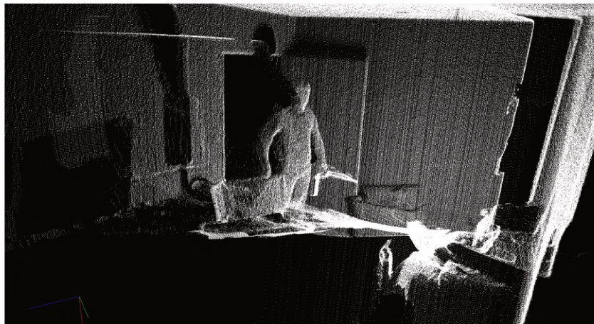
FIGURE 1.16 – Nuage de points reconstruit à l'aide d'un LiDAR mono-nappe combiné à un servomoteur.
