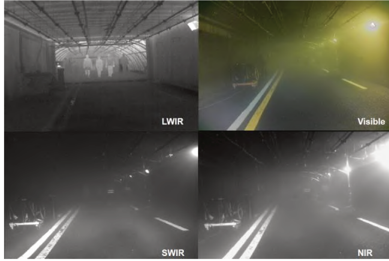
FIGURE 1.23 – Tunnel en conditions de brouillard, vu par des caméras scrutant le spectre visible, infrarouge proche (NIR), infrarouge courte longueur d’onde (SWIR) et longue longueur d’onde (LWIR) Pinchon et al. (2018)
