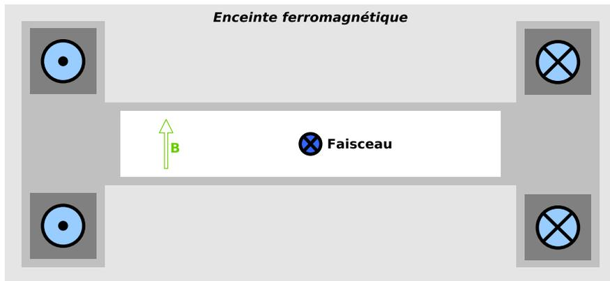
FIGURE 6.16 – Section d'un électroaimant simple [42]
