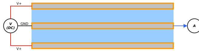
FIGURE 7.14 – Schéma de principe du volume de détection de la chambre LoDoRaM (vue de dessus) [54]
