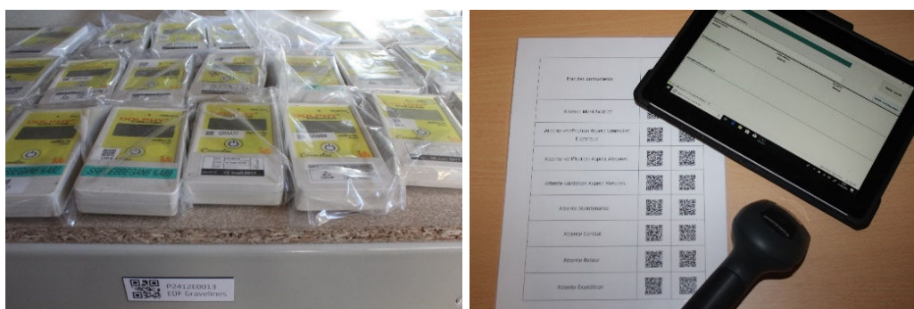
FIGURE 9.3 – DOLPHY Gamma identifiés (à gauche) et application scan-2-loc permettant l'affectation des instruments à une position (à droite) [67]
