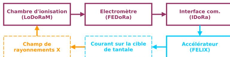
FIGURE 7.15 – Schéma de principe de la chaîne de monitoring complète
