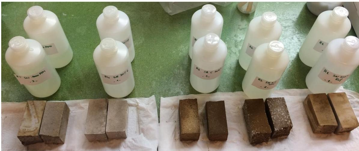
Figure 74: Echantillons après essais de lixiviation
