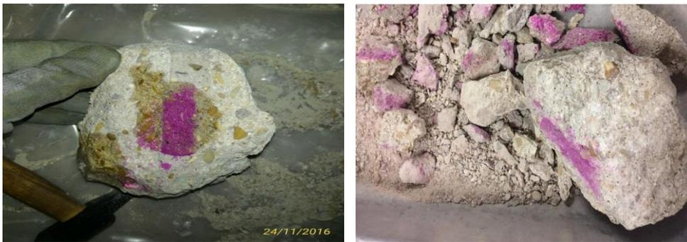
*Figure 16: Blocs de bétons anciens pulvérisés de phénolphtaléine*
