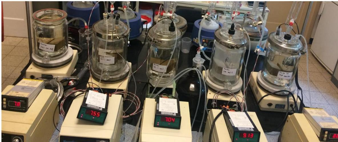
Figure 75: Dispositifs de LEACHCRETE avec un pH 7.
