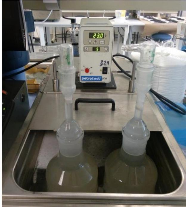
Figure 21 : Mise en place des pycnomètres dans le bain thermostaté
