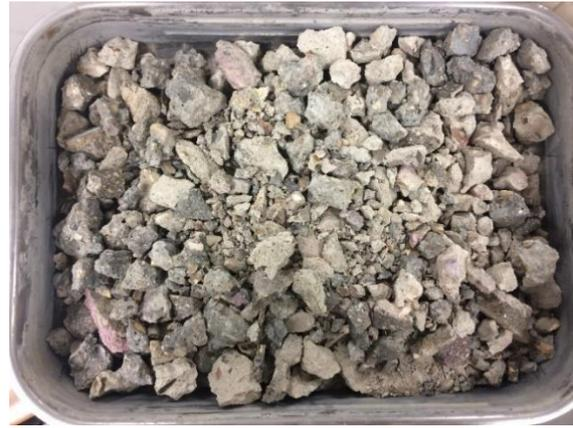
Figure 12 : Concasseur à mâchoires Retsch BB 50    Figure 13 : Echantillons concassés 0-4 mm
