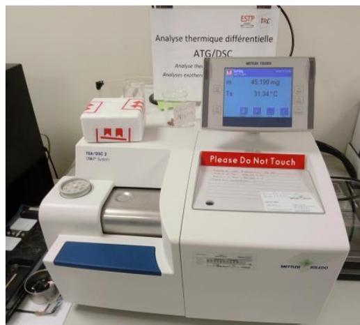
*Figure 26 : Appareil ATG METTLER*
