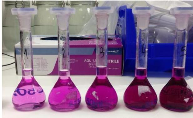
Figure 34: Solutions étalons pour la calibration du spectrophotomètre
