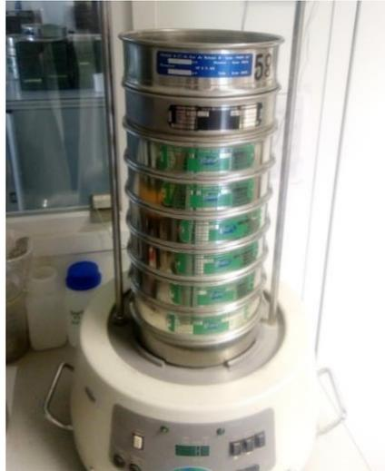
Figure 14: Tamiseuse mécanique
