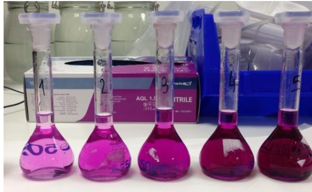
Figure 34: Solutions étalons pour la calibration du spectrophotomètre
