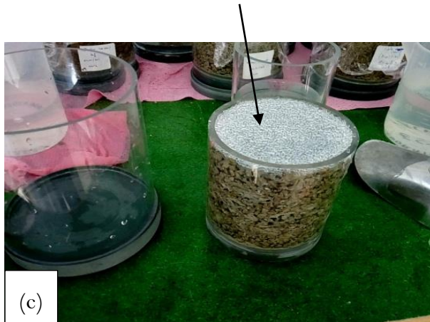
Figure 28 : Différentes étapes de préparation d'un essai de lixiviation pour un échantillon granulaire selon la norme NEN 7347 : (a) Préparation de l'échantillon avec saturation à l'eau déminéralisée ; (b) Compactage de l'échantillon à l'aide d'une dame de 200 g et 20 cm de hauteur de chute ; (c) Mise en place de l'échantillon et des billes de verre à une épaisseur de 2 cm ; (d) Mise en place de l'échantillon préparé dans un sceau rempli d'eau déminéralisée
