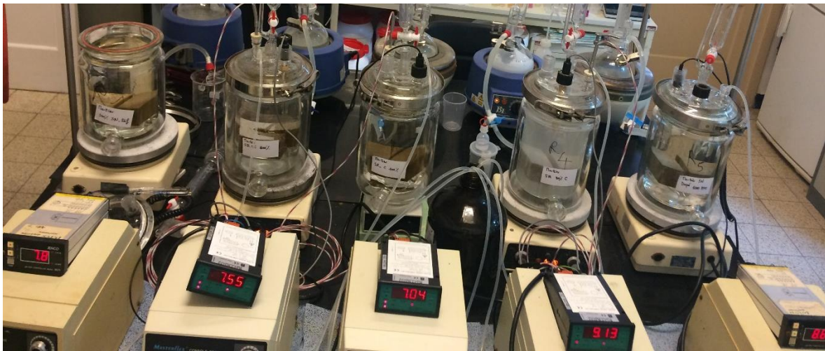
Figure 75: Dispositifs de LEACHCRETE avec un pH 7.
