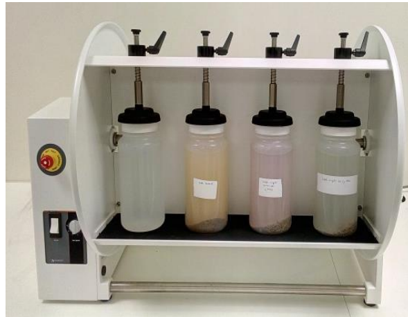
Figure 29: Essai de lixiviation de conformité EN 12457-2 sur échantillons de granulats recyclés
