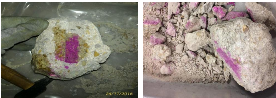
Figure 16: Blocs de bétons anciens pulvérisés de phénolphtaléine
