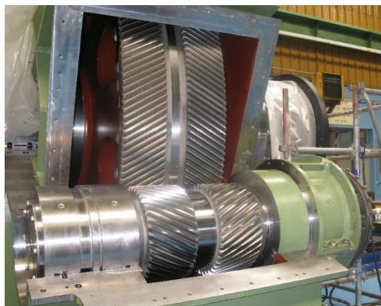
Figure 1 : Illustration d'un réducteur mécanique nitruré (Naval Group).
