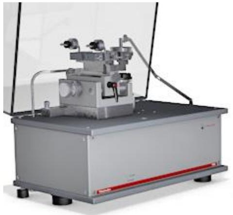
Figure 2.12 : Tribomètre pion-disque (zoom sur la contact pion-disque en Figure 2.13).
