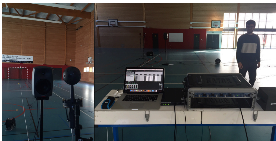
FIGURE A.1 – Photos de l'enregistrement des réponses impulsionnelles de la salle de sport. La photo de gauche montre de près le haut-parleur, placé à 1 m du microphone ambisonique. La photo de droite montre le dispositif d'enregistrement, comprenant de gauche à droite la session d'enregistrement sur Reaper, l'interface audio Eigenmike et la carte son RME Fireface 800.
