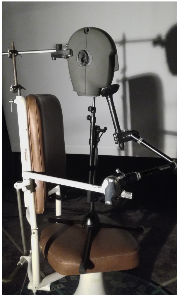
FIGURE 4.3 – Position de la tête artificielle, maintenue par l'appui-tête et la mentonnière durant l'enregistrement des stimuli.
