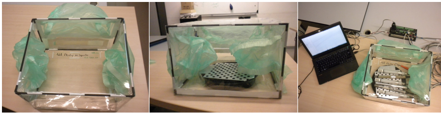
Figure 4.1 – Module développé pour l'ajustage des sondes hygrométriques.
