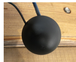
Figure 3.2 – Cliché d'un globe noir en toiture.
