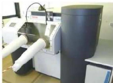
**Figure 2-13.** Spectromètre XPS K-alpha (ThermoFisher Scientific) et sa boîte à gants
