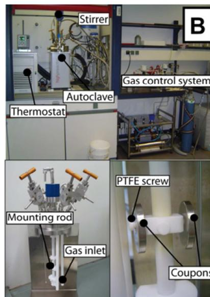
**Figure 1-21.** Test de corrosion en laboratoire dans un autoclave<sup>80</sup>
