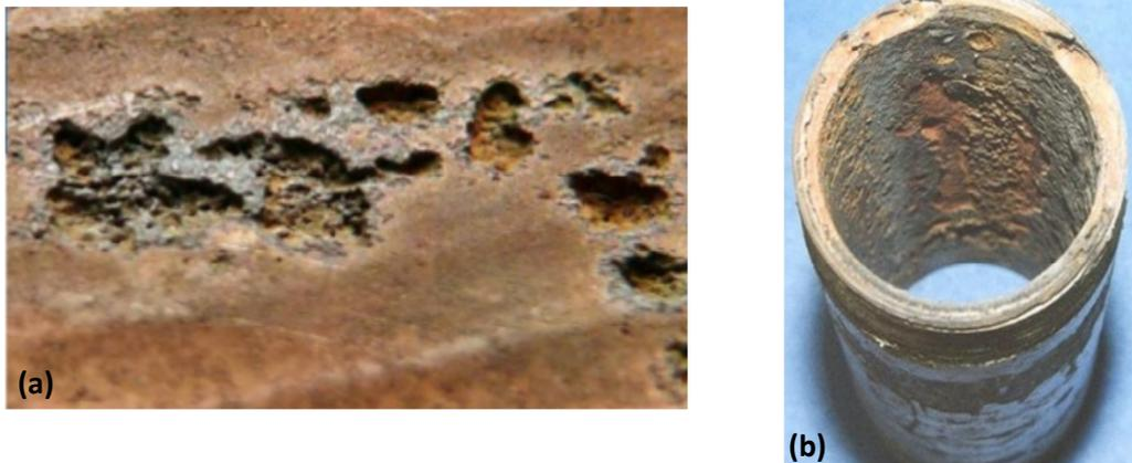
**Figure 1-18.** Exemples de corrosion par piqûres (a) et par crevasses (b) dans des installations<sup>57</sup>
