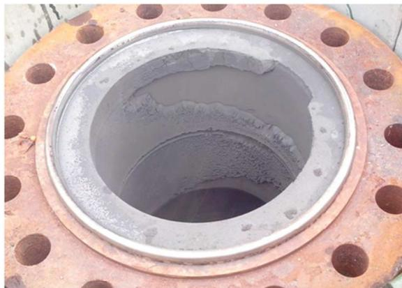
**Figure 1-17.** Corrosion uniforme observée en tête de puits géothermal<sup>53</sup>
