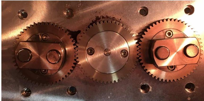
**Figure 2-8.** Photographie du système d'engrenage permettant l'agitation
