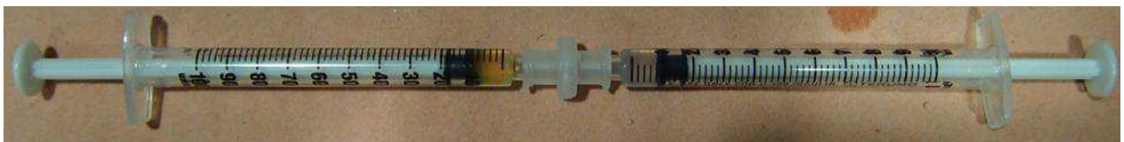
Figure 43 : Photo des seringues connectées à l'aide d'un connecteur mono-voie, pour la réalisation des mélanges colle-lipiodol, à l'UTC de Compiègne.
