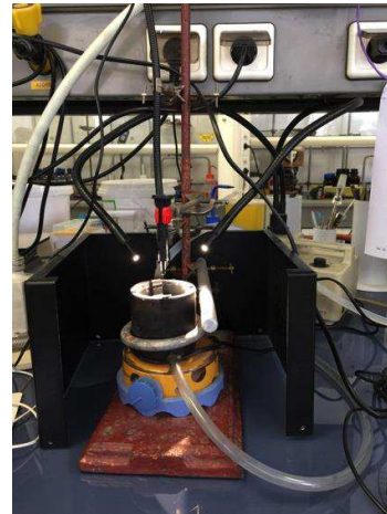
Figure 19 : Photo du montage expérimental pour évaluer les TP des mélanges lipiodol-colle au sein du laboratoire Guerbet..
