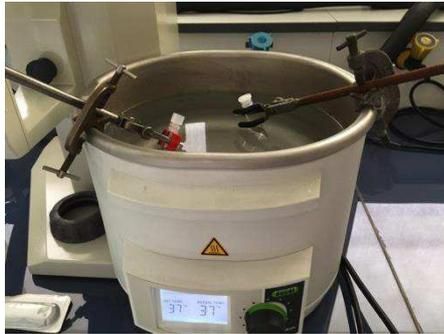
Figure 21 : Bain marie à 37°C permettant de réchauffer colle et lipiodol<sup>®</sup> à 37°C.
