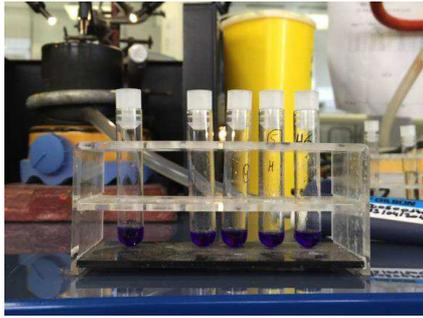
Figure 22: Portoir pour tubes à hémolyse contenant les mélanges colle-lipiodol.
