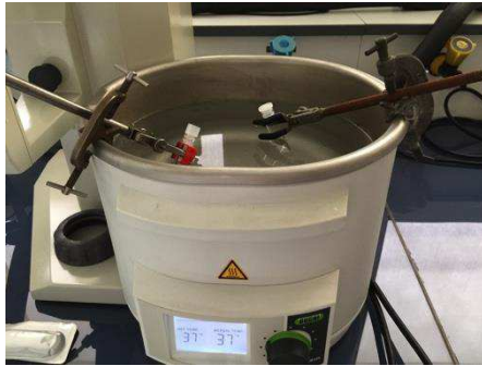
Figure 21 : Bain marie à 37°C permettant de réchauffer colle et lipiodol ® à 37°C.
