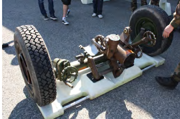
FIGURE 1 – Prototype de structure de transport, chargé d'un essieu de mortier.
