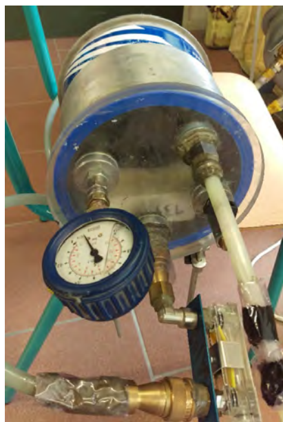
FIGURE 115 – Échantillon dans la cuve à vide pour dégazage.
