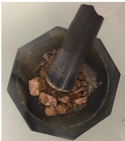
Figure 8: broyage de l'échantillon dans un mortier à agathe
