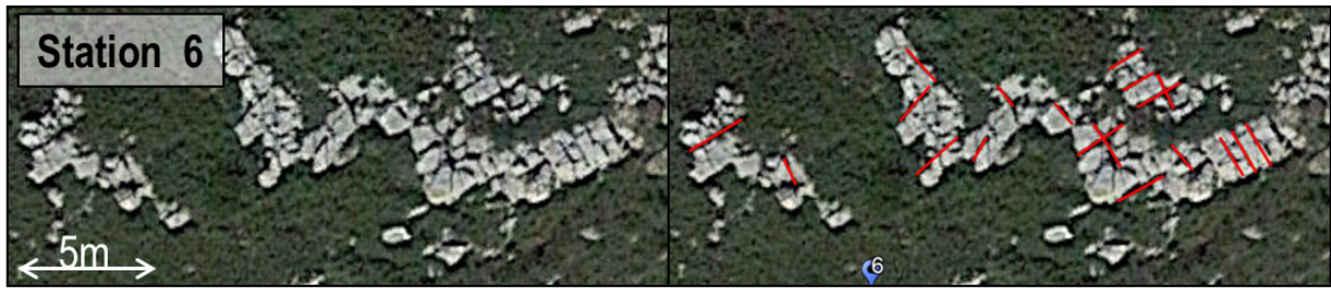
Figure 4.73 : Image Google Earth® des discontinuités régulières, mesurées en photo aérienne dans le substratum Jurassique. Photo aérienne de la station 6 (voir Figure. 4.1).
