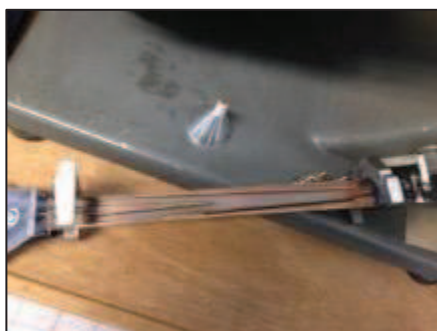
Rail avec séparation entre H+ et H-
