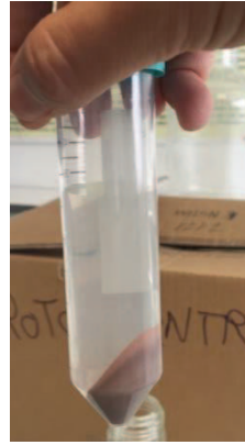
Figure 15: ajout de l'échantillon dans la centrifugeuse, centrifugation à 3000t pendant 45min, la solution surnatante à vider
