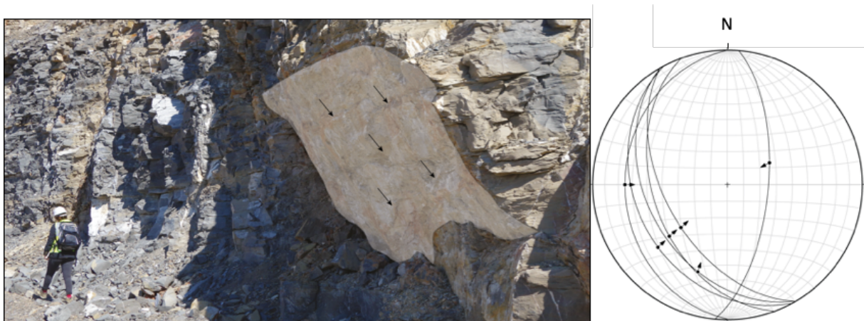
Figure 4.86 : Photo d'une faille inverse néoformée (n=6) et stéréogramme des failles inverses néoformées
