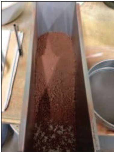
Bac à poudre : plusieurs granulométries sont visibles
