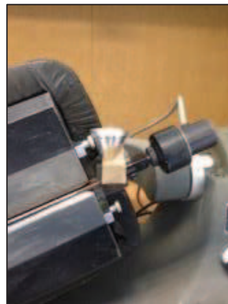
Dispositif Frantz démonté
