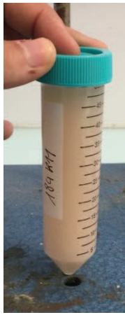
Figure 19: fraction infra2 récupérée avec ajout d'eau distillée avant la centrifugation
