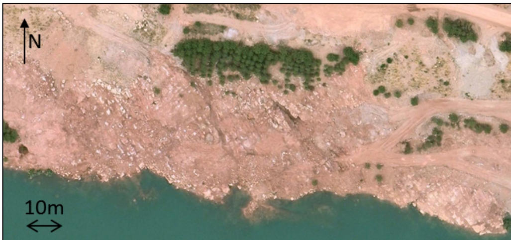
Figure 4.68 : Image Google Earth dans la zone du lac de l'Olivet. Les discontinuités dans le mur Jurassique sont rectilignes et utilisées par la karstification.
