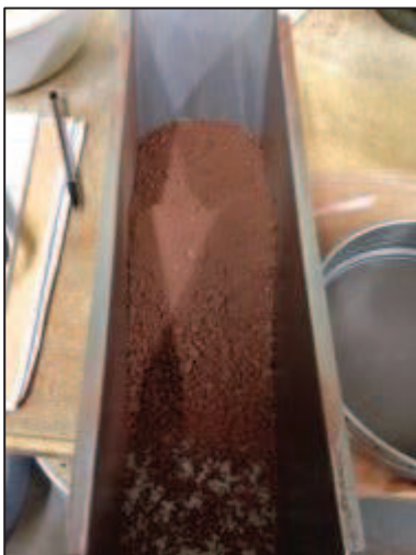
Bac à poudre : plusieurs granulométries sont visibles
