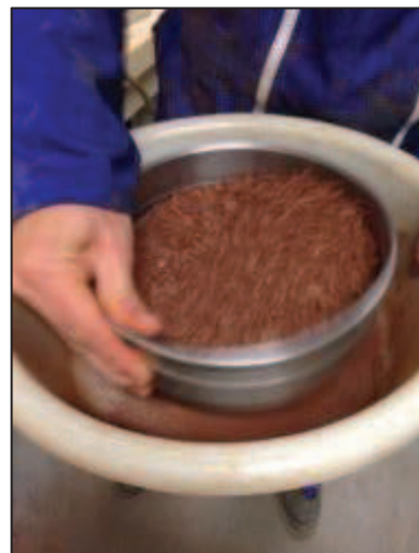
Tamisage de la poudre obtenue, broyage des morceaux restants
