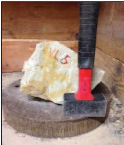
Figure 1 : Montage : échantillon sur une plaque d'acier et marteau. Cette étape sert à réduire la taille des blocs pour ensuite les concasser dans le broyeur
